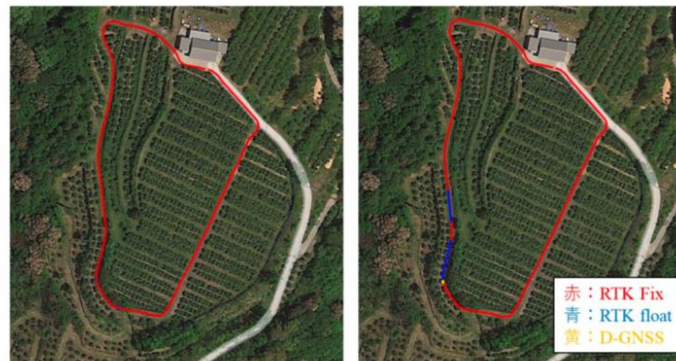
Figure 2 測位精度の比較（左：CLAS、右：RTK-GNSS）
